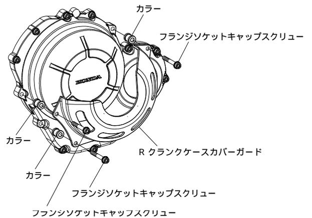
フランジソケットキャップスクリューを規定トルクまで締め付けます。
