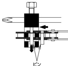
・ピンを押し出し側のプレートから外れるまで押し出したら、一旦イジェクトボルトを緩め、ドライブチェーンをカuttingベースより外します。
