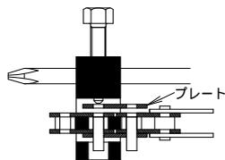
・ドライブチェーンのピンが押し出し側のプレートから抜けるまでイジェクトボルトを締め込みます。
