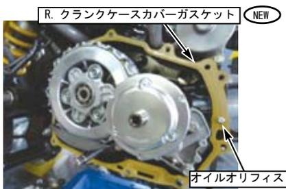
○ R. クランクケースカバー及びクランプを取り付け、ボルトを対角に数回に分け規定トルクまで締め付ける。
