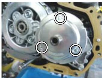
○ R. クランクケースカバーのボールベアリングが抜けてきていないか、オイルフィルターカバーとボールベアリングとの干渉痕がないかを確認する。
