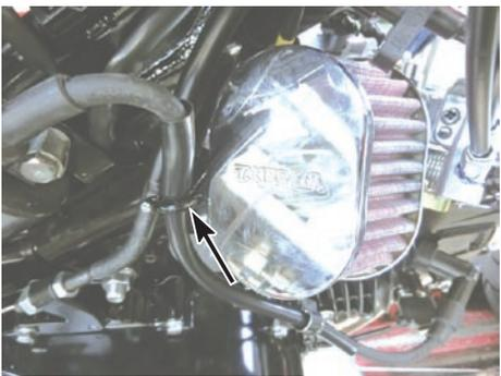
ラバーの切り欠き部をスロットルボディーの凸部に合わせ取り付けます。
