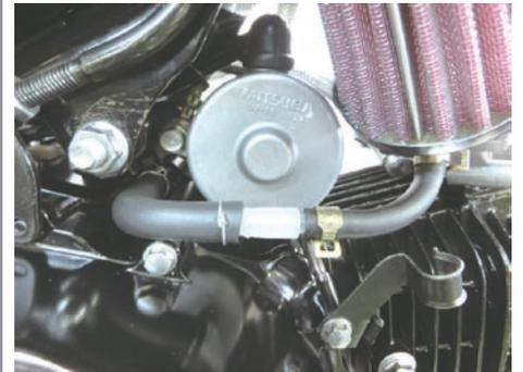
弊社製オイルキャッチタンクキットと併用される場合はエアクリーナーケースに接続するチューブをエアフィルターに接続します。
