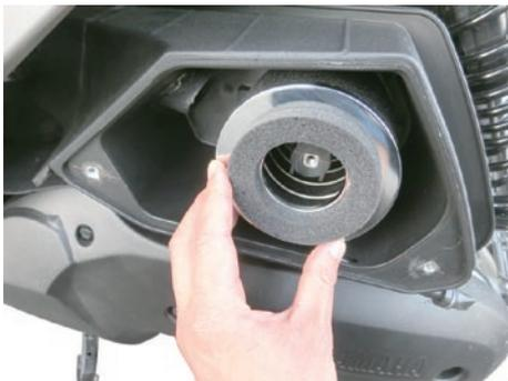
3. ハイフローフィルターの中心の穴とクリーナーケースカバーの凸部を合わせ取り付けます。
