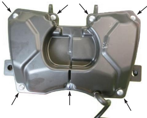
3. 純正エレメントとワイヤスクリーンを取り外し、パワーフィルターとワイヤスクリーンを取り付けます。
