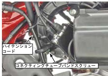
○MAP センサーのカブラ 2P(黒)を取り外し、MAP センサーに付いているノーマルのチューブはキット付属品に交換する為取り外します。
