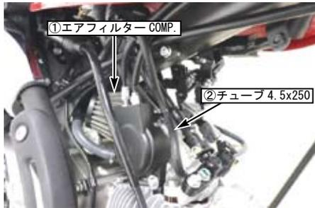
○写真を参考に①エアフィルター COMP. の ラバーインシュレーターにバンドを入れた状態で、フレームとセルモーターに干渉しない位置でスロットルに取り付けます。
