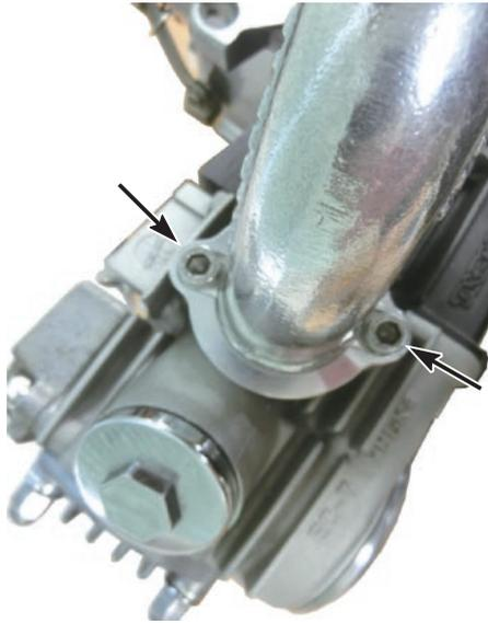
※キャブレターがクランクケースに干渉する場合等は、シリンダーヘッドにインレットパイプガスケット、インシュレーター ( $\phi 25$ )、インレットパイプガスケット、マニホールドCOMP. の順で取り付け 6x25 のソケットキャップスクリューで仮締めします。
