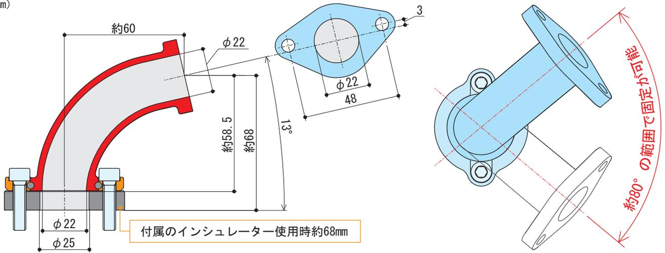
1. シリンダーヘッドにインレットパイプガスケット、マニホールドCOMP. の順で取り付け 6x16 のソケットキャップスクリューで仮締めします。
