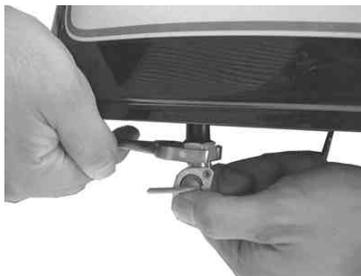
フューエルチューブをフューエルコック、キャブレターに取り付け チューブクリップを取り付けます。
