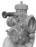
○アジャストスクリューCOMP. にSTD、D、スプリングを取り付け、キャブレターに取り付けます。
