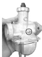
○アジャストスクリューCOMP.にSTD.スプリング、ワッシャ、Oリングを取り付け、キャブレターに取り付けます。
