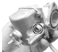
○パイロットスクリューにスプリング、ワッシャ、Oリングを取り付け、キャブレターに取り付けます。
