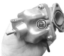
○風通しの良い場所でエンジンを始動させ、パイロットスクリューを調整します。
