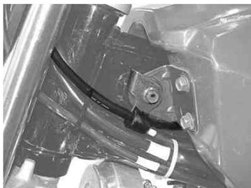
4. キット付属のフューエルホースで、燃料タンクとキャブレターを接続し、フューエルコックを開いて各部からのガソリンの漏れの有無を確認します。
