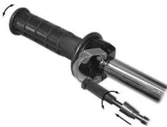
2. スロットルを数回スナップさせ、引っかかりやスロットルバルブの全開状態を確認します。
