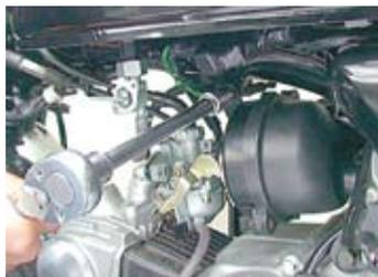
○スロットルバルブをキャブレターから取り外し、スロットルバルブとスロットルケーブルを分離し、スロットルケーブルからトップカバーを抜き取ります。
