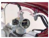
〇チョークレバーを引きエンジン を始動させ各部からの吸気漏れ の有無を確認します。
