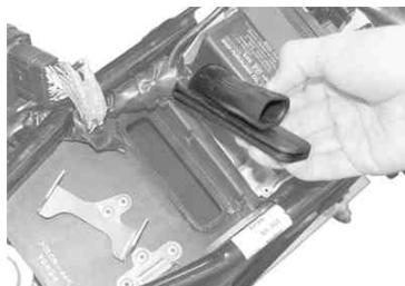
3. 車体のメインハーネスから、ECU側のケーブルまで分岐されている部分のビニールテープやカバーを剥がし、配線を露出させます。
