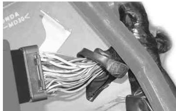
4. 純正ハーネスの、〔桃/緑〕・〔黒/青〕・〔緑〕(緑はハーネスの束に3本ありますが、どれでも構いません)の3本をECU側ケーブルの根元から50mm程度の所で切断し、下図を参照しオス・メスに注意して、付属のギボシ端子を取り付け加工します。
