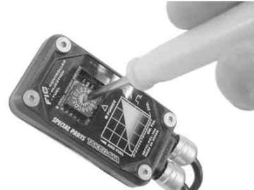
2. スイッチは、矢印形状になっている部分が指す数値もしくは文字が設定値となり、“0”の時は純正ECUと同じ噴射量（増量の無い状態）となります。“1”から順に“F”まで時計回りに回す程、燃料噴射量が純正ECUより多くなります。
