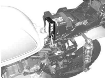
8. 弊社製バッテリーケースキットを併用される場合、車両左側に移設されたバッテリーケース前部やフューエルタンクとフレームの隙間等に設置して下さい。
