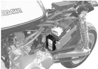
9. タイラップで適宜配線を固定し、フューエルタンクとシートを元通り組み付けます。
