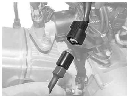
3. F Iコントローラーのハーネスを車両ハーネスと共に這わせて、適宜キット付属のタイラップで固定し、サイドカバー内やシート下等雨や水が直接掛からない場所にF Iコントローラー本体を設置します。設置する際、キット付属のマジックテープをご使用下さい。
