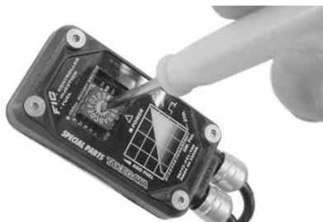
2. スイッチは、矢印形状になっている部分が指す数値もしくは文字が設定値となり、“0”の時はほぼ純正ECUと同じ噴射量（増量の無い状態）となります。“1”から順に“F”まで時計回りに回す程、燃料噴射量が純正ECUより多くなります。
