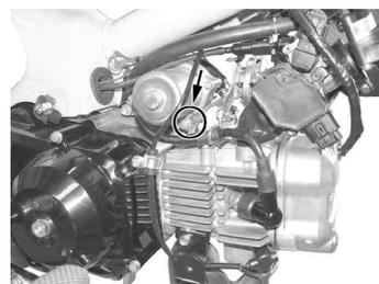
3. スロットルボディに取り付けられているスロットルドラムカバーの固定スクリーを2本を取り外し、カバーを取り外します。
