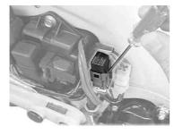
リレーに隠れていたスクリューと、フレームアースコードを共締めし、 リレーを元通り取り付けます。
