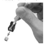
b.細い針状の物等を用いて、純正カプラ内部のターミナルを固定しているツメを少しだけ起こしながら、カプラからコードを1本ずつ引抜きます。
