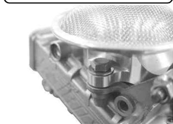
スロットルワイヤーブラケットにスロットルケーブルを組み付けます。
