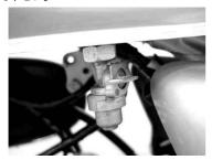
8. インレットパイプと キャブレターASSY の間に キャブレ ターガスケットを挟み、 ソケットキャップスクリュー2本にて締 め付けて下さい。
