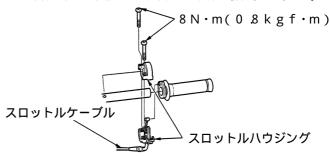
11.シリンダーヘッドとインレットパイプを固定してあるボルト2本を取り外し、キャブレターをインレットパイプ、スロットルケーブル付きで、取り外して下さい。
