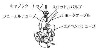
8 . クランクケースセルモーター部分のチョークケーブルを取り外し、 抜き取ったボルトを規定トルクで締め付けて下さい。
