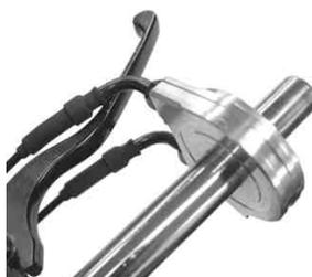
スロットルパイブCOMP.のフランジ部及びハンドルパイブのスロットル摺動部にグリスを薄く塗布し、スロットルパイブCOMP.をハンドルパイブに通します。
