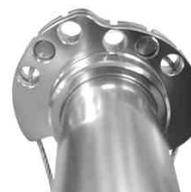
ケーブルの遊び調整を行った際、調整が出来ない場合はケーブルエンドの接続位置を変更します。ハウジングに取り付けられているストッパー(ソケットセットスクリュー)は、1本引きで使用する場合の戻り過ぎを防ぐ為の物です。2本引きで使用するには、スロットルパイブフランジ部に干渉しない位置で固定して下さい。
