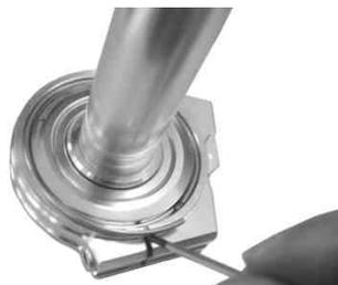
クリップを外す際には、ハウジングの切り欠き部から5～10mm程度の位置にクリップの先端をセットし、ハウジングの切り欠き部よりマイナスドライバー等でクリップを引き上げると容易に外れます。
