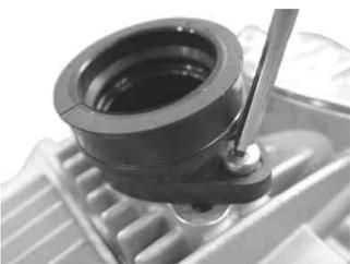
キット内のスピゴットリングにOリング35mmを取り付け、キャブレターに付いているスピゴットリングと付け替えます。スピゴットリングのネジ部に液状ガスケット(スリーボンド1104相当品)を塗布して、確実にねじ込んで下さい。
