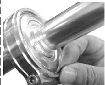
キャップスクリーを規定トルクで締め付け、スロットルA S S Y を固定します。
