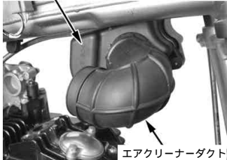
エアクリーナーダクト
