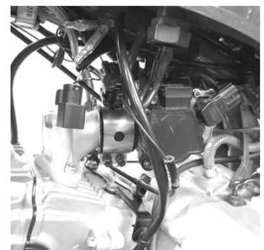
スロットルケーブルを取り付けスロットルグリッパ部で5mm程度の遊びが出来るようにスロットルケーブルのアジャストナットを調整します。ハンドルを左右いっぱい切った状態でスロットルケーブルに若干の遊びがある様、取り回しを調整します。
