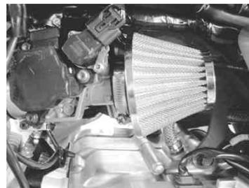
ノーマルのホースとキット付属のチューブを適宜切断し、キット付属のコネクターで繋いでエアフィルターに接続して下さい。
