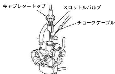
クランクケースセルモーター部分のチョークケーブルを取り外します。抜き取ったボルトを規定トルクで締め付けます。
