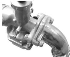
付属のキャブレターのトップカバーを外し、スロットルバルブスプリング、スロットルバルブを取り出します。スロットルケーブルを無理が掛からない様にキャブレターに取り回します。スロットルケーブルにキャブレタートップを取り付けスロットルバルブスプリングを圧縮した状態でインナーケーブルをスロットルバルブに取り付けます。
