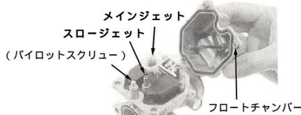
フロートチャンバーを元通りに取り付けます。インレットパイプとキャブレターの間にキャブレターガスケットを挟み、ソケットキャップスクリュー 6 x 2.5 2本とロックナット 6 mm 2個を規定トルクで締め付けます。
