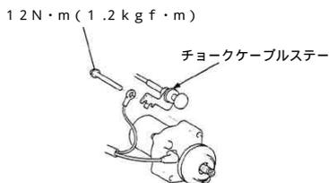
スロットルケーブルロックナットを緩めスロットルハウジング取り付けスクリュー2本を抜き取りスロットルハウジングを分割します。
