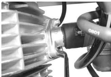
12. スロットルハウジングのパンスクリューを外します。スロットルパイプ、スロットルハウジングからスロットルケーブルを外します。ノーマルのスロットルケーブルを車両から抜き取ります。スロットルパイプの汚れや古いグリス等を拭き取り、躍動面に新しいグリスを塗布します。スロットルパイプをハンドルに取り付けます。
