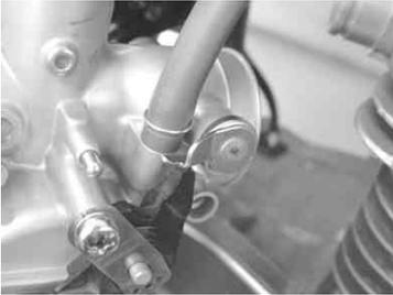
20. インシュレーターCOMP をインレットパイプに差し込み、バンドで締め付けます。
