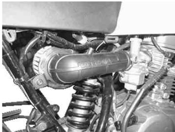
24. コネクティングチューブにストレージタンクホースを取り付け、チューブクリップを取り付けます。
