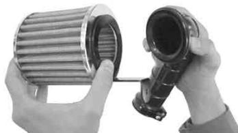
接着面は汚れ、油脂分を取り除き、十分乾燥させた後、ホンダボンドAまたは相当品を薄く塗布し、接着面が乾かないうちにエアフィルターを取り付けます。
