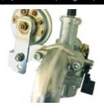
〇付属の①キャブレター ASSY. のトップカバー を外しスロットルバルブスプリング、スロッ トルバルブを取り外します。
