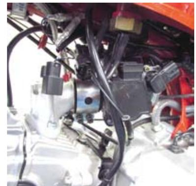
○スロットルケーブルを取り付け、スロットルグリップ部で5mm程度の遊びが出来る様にスロットルケーブルのアジャストナットを調整します。
