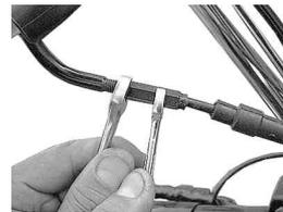
12. フューエルタンクを取り外していた場合、フューエルコックを付け替えて(規定トルク：5~6 N・m (0.5~0.6 kgf・m))、フューエルタンクを取り付け、シートを取り付けます。
