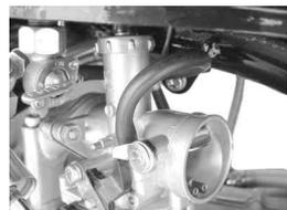
14. チョークレバーを引きエンジンを始動させ各部からの吸気漏れの有無を確認します。チョークレバーを徐々に戻し、回転がスムーズになるまで暖機運転を行いチョークレバーを完全に戻します。エンジン暖気後アイドル回転数が高い場合は、スロットルストップスクリューで調整します。
