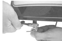
13. フューエルコックの方向、フューエルチューブの長さを調整し、フューエルコック、キャブレターに差し込みチューブクリップを取り付けます。フューエルコックを開き各部からのガソリン漏れの有無を確認します。(コックを開いたまま長時間放置しないで下さい。)
