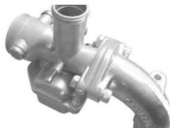
8. 付属のスロットルケーブルを無理が掛からないようにキャブレターまで取り回します。スロットルケーブルにキャブレタートップを取り付けスロットルバルブスプリングを圧縮した状態でインナーケーブルをスロットルバルブに取り付けます。
