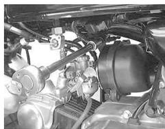
3. インレットパイプ締め付けボルト、エアクリーナーマウントボルトを外し、スロットルバルブをキャブレターから取り外しエアクリーナーBOX、インレットパイプごとキャブレターを取り外します。インテークポート内に異物等が入らないよう注意して下さい。
