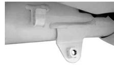
11. スロットルグリップ部で5 mm程度の遊びが出来るようにスロットルケーブルのアジャスターを調整します。スロットルを数回スナップさせ引っかかりやスロットルバルブの全開状態を確認します。ステアリングを左右にいっぱい切った状態でスロットルに遊びがある事を確認して下さい。
