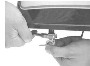
13. フューエルコックの方向、フューエルチューブの長さを調整し、フューエルコック、キャブレターに差し込みチューブクリップを取り付けます。フューエルコックを開き各部からのガソリン漏れの有無を確認します。(コックを開いたまま長時間放置しないで下さい。)
