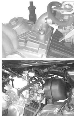
4. スロットルバルブをキャブレターから取り外し、スロットルバルブとスロットルケーブルを分離し、スロットルケーブルからトップカバーを抜き取ります。
