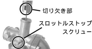
10. シリンダーヘッドとインレットパイプの間に、インレットパイプガスケットを挟み、ソケットキャップスクリー6×2.0 2本を規定トルクで締め付けます。
