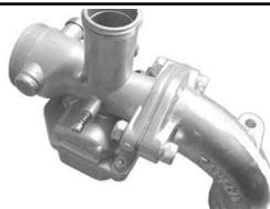
8. 付属のスロットルケーブルを無理が掛からないようにキャブレターまで取り回します。スロットルケーブルにキャブレタートップを取り付けスロットルバルブスプリングを圧縮した状態でインナーケーブルをスロットルバルブに取り付けます。
