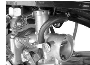
14. エアフィルターを取り付け、バンドを締め付けます。
