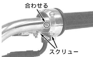
3. スロットルケーブルを無理が掛からない様取り回し、ロックナットを締め付けます。
