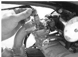
エアクリーナーマウントボルト、インレットパイプマウントボルトを外し、インレットパイプごとキャブレターを取り外します。インテークポート内に異物等が入らないよう注意して下さい。
