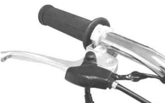
11. スロットル摺動面にグリスを塗布し、スロットルハウジングを取り付けます。パンスクリューを締め付けます。前方のパンスクリューを締め付けた後、後方のパンスクリューを締め付けます。
