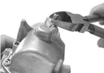
10. スロットルハウジングロア側にキット内のスロットルケーブルを取り付け、インナーケーブルをキット内のスロットルパイプと接続させます。
