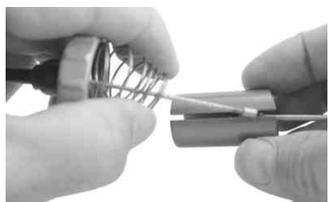
16. スロットルバルブの切り欠き部をキャブレターのスロットルストップスクリューに合わせ、取り付けます。
