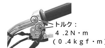
12. スロットルケーブルのロックナットを締め付けます。
