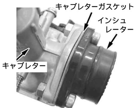
20. PD22キャブレターのトップカバーを外して、スプリング、スロットルバルブを抜き取ります。スロットルケーブルにトップカバーを取り付け、スプリングを入れてスロットルバルブをインナーケーブルに取り付けます。スロットルバルブの切り欠き部をスロットルストップスクリューに合わせてキャブレターに取り付けます。
