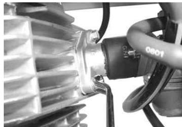
12. スロットルハウジングのパンスクリューを外します。スロットルパイプ、スロットルハウジングからスロットルケーブルを外します。ノーマルのスロットルケーブルを車両から抜き取ります。
