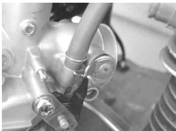
22. インシュレーターCOMPをインレットパイプに差し込み、バンドで締め付けます。
