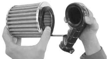
接着面は汚れ、油脂分を取り除き、十分乾燥させた後、ホンダボンドAまたは相当品を薄く塗布し、接着面が乾かないうちにエアフィルターを取り付けます。接着剤に添付されている仕様説明書に従って使用して下さい。エアフィルター取り付け後、接着剤が固まるまで最低2時間は放置して下さい。
