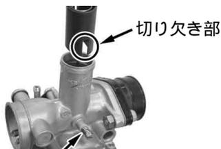
21. 付属のフューエルチューブをキャブレターに差し込み、チューブクリップを取り付けます。
