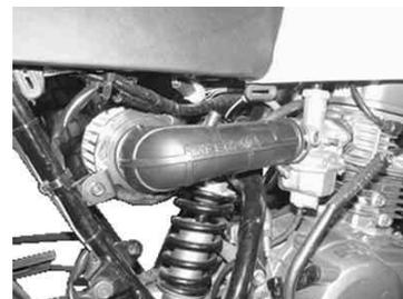
26. コネクティングチューブにストレージタンクホースを取り付け、チューブクリップを取り付けます。
