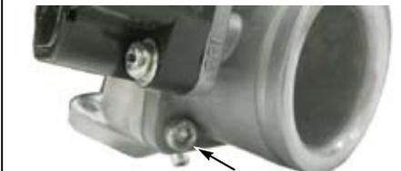
○インレットパイプにキット付属の⑥Oリング29mmを取り付けます。
