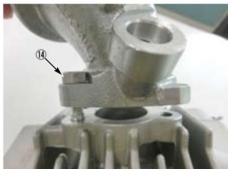
○⑬スクリュー 6x18 を使用し、インレットパイプを取り付けます。
