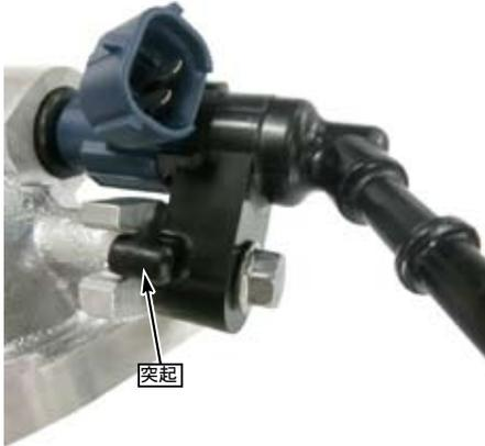
○⑦アルミワッシャ、⑩ユニオンを取り付け規定トルクで締め付けます。
