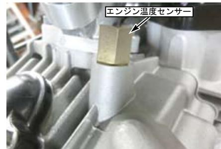
○取り外しの逆手順でアイドルスピードコントロールバルブアクチュエータ、スロットルボディアシセンサー、エンジン温度センサーのカブラを接続します。
