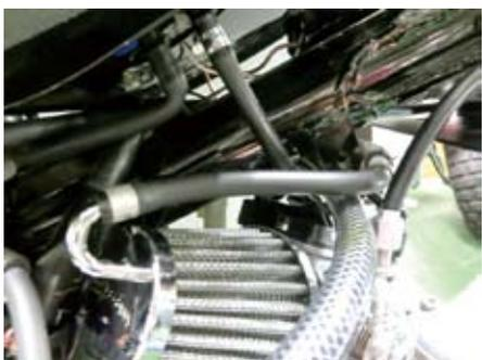
○ノーマルクラッチカバーをご使用の場合、エアフィルターとクラッチケーブルが干渉する為、画像を参考に取り回しを変更して下さい。
