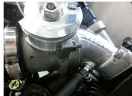
○各部を点検しボルト、ナットに緩みがないか確認して下さい。
