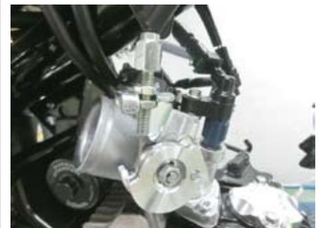
○スロットルケーブルの遊びの調整を行います。アッパナット [A] を緩めロアナット [B] を回してスロットルグリップの遊びを2～3mmに調整し、アッパナットを締め付けます。ハンドルを左右いっぱい切りアイドリング回転数が変化しない事を確認します。
