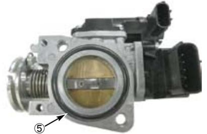
○⑬スクリュー6x20を使用し、スロットルボディーにインレットパイプを取り付けます。
