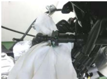
○マイナスドライバー [A] をジョイントロック [B] の溝に差し込みドライバーを回して、ジョイントロックを外します。
