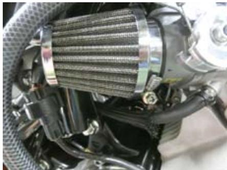
○弊社製オイルキャッチタンクを併用しない場合、ノーマルのクランクケースブリーザーホースを適宜切断し、⑨ホースコネクター、⑮チューブ5x200、⑧ホースクランプを使用し③エアフィルターと接続します。
