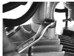
○スロットルハウジングのパンスクリュー2本を外し、スロットルケーブルを抜き取ります。
