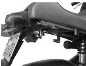
○フューエルコックをOFFにし、キャブレター側のフューエルホースを抜きます。ボルト2本を取り外します。
