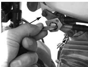
○フューエルタンク取り付けナットを外し、フューエルコックごとフューエルタンクを外します。コネクティングチューブバンドのパンスクリューと、フランジボルト2本を外し、エアクリーナーケースを取り外します。
