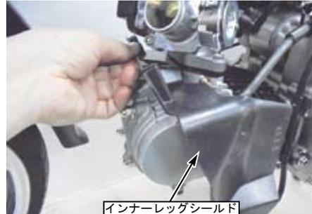
○エアクリナーケースをセットし、コネクティングチューブに⑥バンド(30-45/9)を取り付け、ビッグスロットルボディにはめ込む。ボルト2本にて、エアクリナーケースをフレームに取り付ける。バンドのスクリーンを締め付ける。エアエレメントとエアクリナーケースカバーをスクリーン5本にて取り付け。エアクリナーケースにブリーザーホースを接続する。
