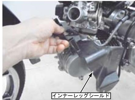
○スロットルボディからセンサーユニット 5P カプラ、IACバルブ 4P カプラの接続を外す。
