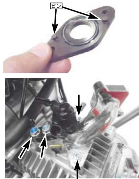
☆ SuperHead 4V+R へ当製品を取り付ける際は、ノーマルのインシュレーターのまま使用すると、インシュレーター径とシリンダーヘッドのポート径との差が大きいため、段差が生じます。専用のインシュレーターを使用して段差をなくす事でよりスムーズな出力特性を得られます。
