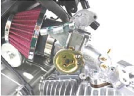
○別売りの弊社製インジェクタ ASSY. とノーマルのシールリングを③インテークマニホールド COMP. に差し込み、インジェクタジョイントをノーマルのボルト2本にて取り付け。
