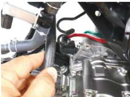
○④エアフィルター COMP. のラバーインシュレーターにバンドを入れた状態にて①ビッグスロットルボディの突起にラバーインシュレーターの切り欠きを合わせつつ、しっかりと締め込みバンドを締め付けて固定する。なお、ラバーインシュレーターの切り欠きはモンキー 125 と GROM は "B" を、ダックス 125 は "A" を合わせる事。
