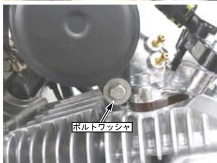
○ダックス 125 はサービスマニュアルを参照し、スロットルボディカバーを取り付ける。(ボルトの取り付け穴位置がノーマルと異なる為、多少歪んだ状態となるが、そのまま取り付ける。)
