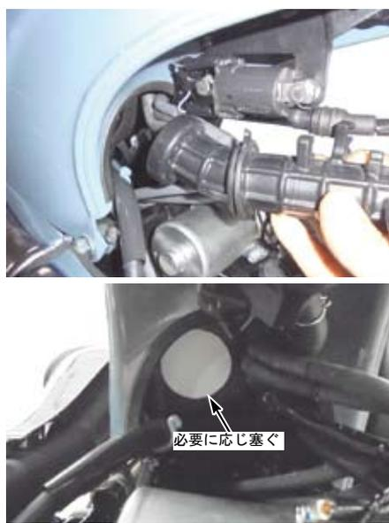
○クランクケースからのブリーザーホースを取り外す。ホースクランプ2個は再使用するので取り外しておく。
