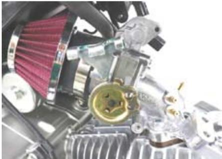
○別売りの弊社製インジェクタ ASSY. とノーマルのシールリングを③インテークマニホールド COMP. に差し込み、インジェクタジョイントをボルト2本にて取り付けする。
