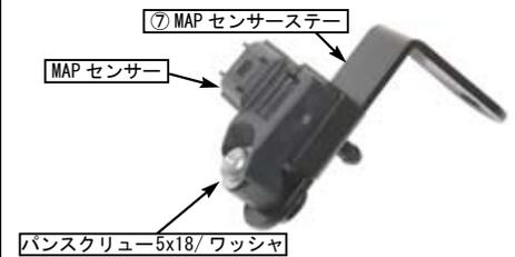
○エアクリーナーケースが取り付けられている右側のネジ穴に⑪フランジソケットキャップスクリュー 6x16 を用いて⑦ MAP センサーステーを取り付ける。
