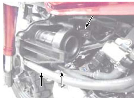
○コネクティングチューブのバンドのスクリーンを緩める。エアクリーナーケースとフレームを止めているボルト3本を取り外す。コネクティングチューブをスロットルボディから抜き取り、エアクリーナーケースを取り外す。
