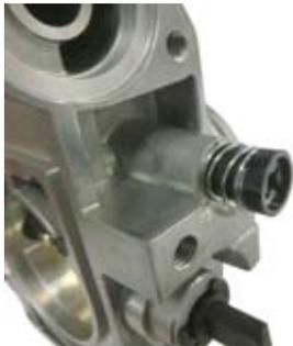
○②ラバーパッキンを取り付けた①ビッグスロットルボディを⑩ソケットキャップスクリュー 6x20 2本を使用して③インテークマニホールドCOMP. に取り付け。
