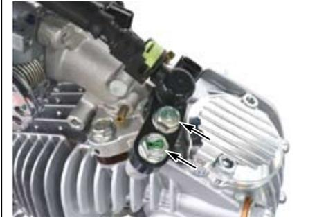
○インレットパイプのボルト2本を取り外し、マニホールド/スロットルボディとインシュレーターをシリンダーヘッドから取り出す。
