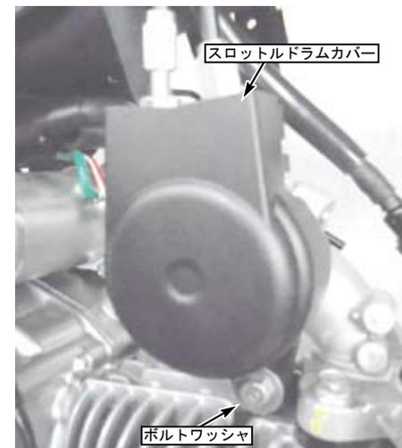
○ロックナットを緩め、スロットルケーブル2本をケーブルホルダーから取り外す。スロットルドラムからインナーケーブル2本を取り外す。
