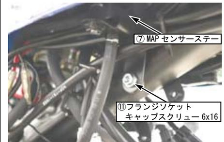
○⑩チューブ 4.5x250 を適切な長さにカットし、ノーマルのチューブに使用されていたクランプ2個を使用して MAP センサーと③インテークマニホールド COMP. に接続する。
