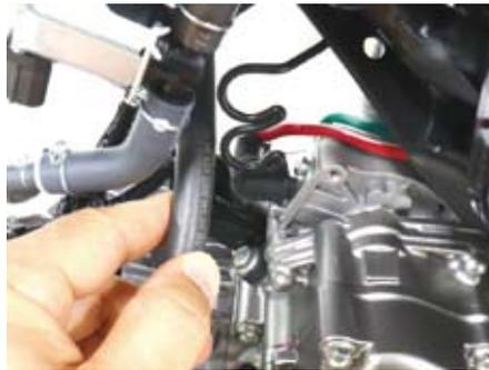
○⑥エアフィルターCOMP. のラバーインシュレーターにバンドを入れた状態にて①ビッグスロットルボディにしっかりと締め込み、バンドを締め付けて固定する。
