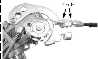
車両の仕様によっては、スロットルワイヤーの取り回しに無理が生じる場合があります。その際には、スロットルワイヤーブラケットを一旦外し、取り付け穴を変えてスロットルワイヤーブラケットの角度を変更して下さい。
