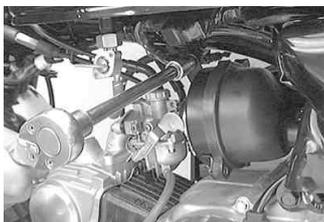
スロットルバルブをキャブレターから取り外し、スロットルバルブとスロットルケーブルを分離し、スロットルケーブルからトップカバーを抜き取ります。スロットルハウジングのパンスクリューを外し、スロットルハウジングを取り外します。
