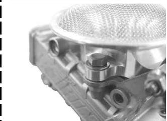
スロットルワイヤーブラケットにスロットルケーブルを組み付けます。
