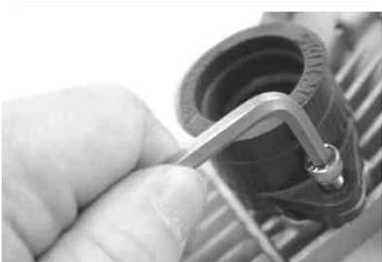
TAKEGAWAの文字が入っている方のマウントアダプターをキャブレターに取り付けます。マウントアダプターのネジ部に液状ガスケット(スリーボンド1104相当品)を塗布して、確実にねじ込んで下さい。
