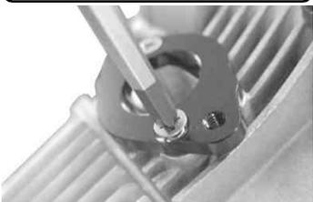
インレットアダプターとインシュレーター間にインレットアダプターガスケットを挟み、ソケットキャップスクリュー6×12 2本で取り付けます。
