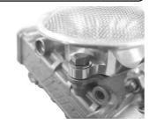
ステープレートにスロットルケー ブルを組み付けます。
