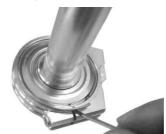
クリップを外す際には、ハウジングの切り欠き部から5~10mm 程度の位置にクリップの先端をセットし、ハウジングの切り欠き 部よりマイナスドライバー等でクリップを引き上げると容易に外れます。
