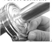
キャップスクリューを規定トル | クで締め付け、スロットルAS | SY.を固定します。 |
