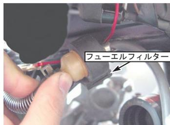
◇フューエルフィルターからキャブレターへのフューエルチューブの取り回しに無理が生じるので、フューエルフィルターをステーから外して下さい。フューエルフィルターはタイラップ等を使用し、固定して下さい。
