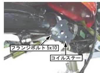
○取り外したイグニッションコイルをイグニッションコイルステーの下側にフランジボルト5x22で取り付け、ボルトを規定トルクで締め付けます。
