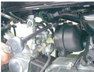
○スロットルバルブをキャブレターから取り外し、スロットルバルブとスロットルケーブルを分離し、スロットルケーブルからトップカバーを抜き取ります。
