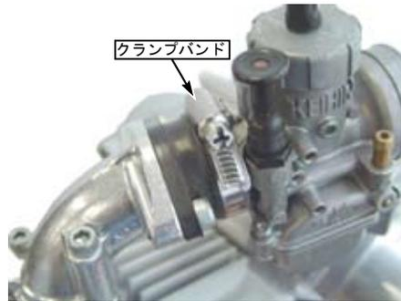
○スロットルケーブルをスロットルハウジング、スロットルパイブに取り付け、ハンドルに取り付けます。
