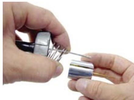
○スロットルバルブの切り欠き部をスロットルストップスクリューに合わせて、キャブレターに取り付けます。
