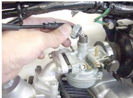
○ストレージタンクのホース（フレーム NO. AB27-1000001 ~ の車両の場合）の接続を外す。
