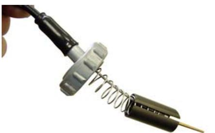
○スロットルバルブの切り欠き部をスロットルストップスクリューに合わせてキャブレターに差し込み、キャブレターのくぼみにトップカバーの凸を合わせて取り付け。
