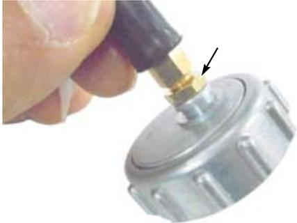
○スロットルケーブルを無理の無い様にキャブレターまで取り回す。スロットルケーブルにトップキャップを取り付け、スロットルバルブスプリングを圧縮した状態でインナーケーブルをスロットルバルブに取り付ける。
