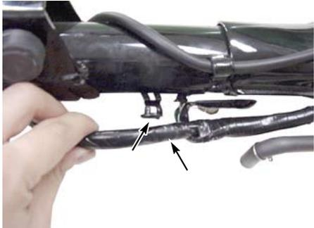
○エアクリーナーのマウントボルトを使用し、アース線をフレームに取り付ける。
