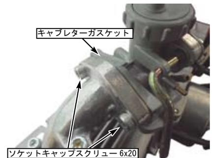
○キャブレター ASSY. のトップカバーを外し、スロットルバルブスプリング、スロットルバルブを抜き取る。トップカバーからアジャスターを一旦取り外し、付属の②ロックナットを取り付けた後、再びトップカバーに取り付ける。
