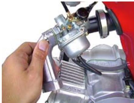
○スロットルケーブルの六角ナットを緩め、ボルト2本を取り外してノーマルスロットルホルダーを分解し、ノーマルスロットルケーブルを取り外す。
