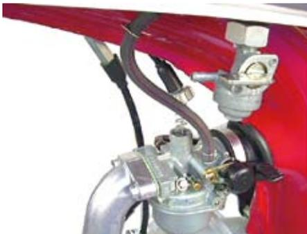
○エアクリーナーコネクティングチューブのバンドのスクリーンを緩める。インレットパイプをシリンダーヘッドに止めているボルト2本を取り外し、ノーマルのインレットパイプ/キャブレターを取り外す。
