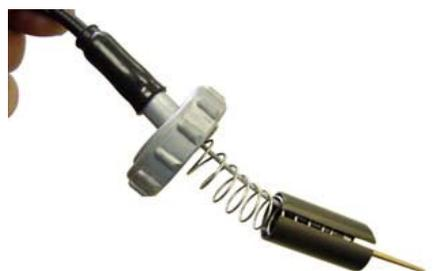
○スロットルバルブの切り欠き部をスロットルストップスクリューに合わせてキャブレターに差し込み、キャブレターのくぼみにトップカバーの凸を合わせて取り付ける。
