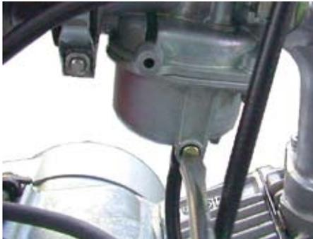
○ノーマルのキャブレターのトップキャップを外し、スロットルバルブをキャブレターから抜き取る。キャブレターのフューエルチューブの接続を外す。
