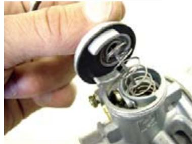
○スロットルグリップ部で 5mm 程度の遊びが出来るようにスロットルケーブルのアジャスターとキャブレターのアジャスターを調整する。この際、ステアリングを左右にいっぱいに切った状態でもスロットルに遊びがある事を確認する。スロットルを数回スナップさせ引っぱりやスロットルバルブの全開状態を確認する。
