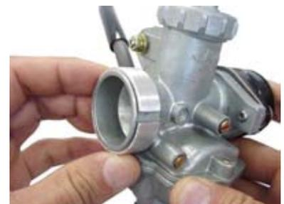
○⑥バンドをキャブレターインシュレーターに取り付け、キャブレターをインレットパイプに差し込みつつ、コネクティングチューブにも差し込む。キャブレターインシュレーターのバンドとコネクティングチューブのバンドのスクリューを締め付け、固定する。弊社製エアフィルターキット取り付けの際は、その取扱説明書に従い取り付ける。
