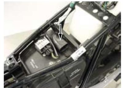
○純正サービスマニュアルを参照し、フューエルタンク、シート、サイドカバーを取り付ける。フューエルコックにフューエルチューブを接続する。
