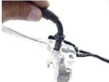
○ノーマルスロットルホルダーに付属の⑫スロットルケーブル COMP. を上記の逆の手順にて取り付ける。
