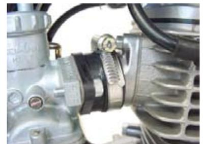
○キャブレター ASSY. のトップカバーを外し、スロットルバルブスプリング、スロットルバルブを抜き取る。トップカバーからアジャスターを一旦取り外し、付属の②ロックナットを取り付けた後、再びトップカバーに取り付ける。
