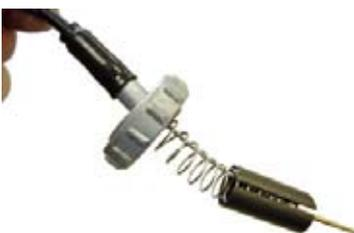
○スロットルバルブの切り欠き部をスロットルストップスクリューに合わせてキャブレターに差し込み、キャブレターのくぼみにトップカバーの凸を合わせて取り付ける。
