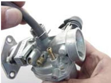
○スロットルケーブルの六角ナットを緩め、ボルト2本を取り外してノーマルスロットルホルダーを分解し、ノーマルスロットルケーブルを取り外す。
