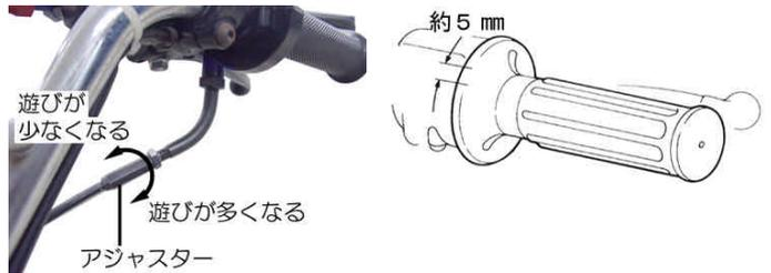
スロットルを数回スナップさせしっかりやスロットルバルブの全開状態を確認します。ステアリングを左右いっぱいに切った状態でもスロットルに遊びがあることを確認して下さい。
