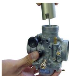
4. キャブレターをインシュレーターに差し込み、クランプバンドで締め付けます。
