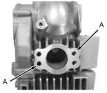
シリンダーヘッドとインレットパ イプの間にインレットパイプガス ケットを挟み、6×20及び6× 45のソケットキャップスク リューを用いて取り付け締め付け ます
