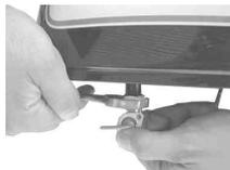
12. フューエルコックの方向、フューエルチューブの長さを調整し、フューエルコック、キャブレターに差し込みチューブクリップを取り付けます。フューエルコックを開き各部からのガソリン漏れの有無を確認します。(コックを開いたまま長時間放置しないで下さい。)
