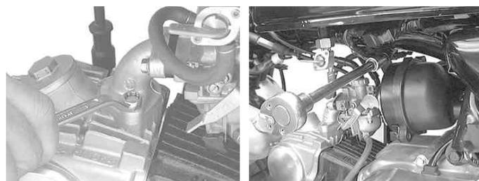
4. スロットルバルブをキャブレターから取り外し、スロットルバルブとスロットルケーブルを分離し、スロットルケーブルからトップカバーを抜き取ります。
