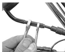
11. フューエルタンクを取り外していた場合、フューエルコックを付け替えて{規定トルク =  $5 \sim 6 \text{ N} \cdot \text{m} (0.5 \sim 0.6 \text{ kgf} \cdot \text{m})$ }、フューエルタンクを取り付け、シートを取り付けます。
