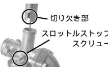
8. スロットルバルブの切り欠き部をスロットルストップスクリューに合わせてキャブレターに取り付けます。
