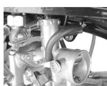
13. チョークレバーを引きエンジンを始動させ各部からの吸気漏れの有無を確認します。チョークレバーを徐々に戻し、回転がスムーズになるまで暖機運転を行いチョークレバーを完全に戻します。エンジン暖気後アイドリングしない場合や、アイドリング回転数が高い場合は、スロットルストップスクリューで調整します。
